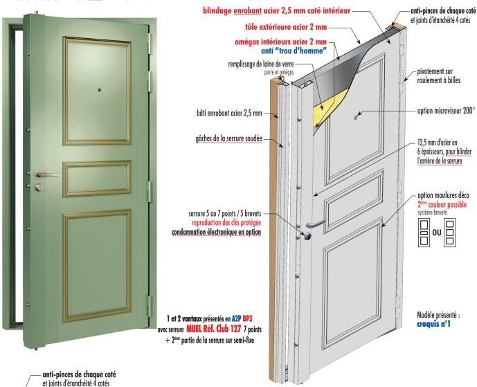
blindage enrobant acier 2,5 mm coté intérieur tôle extérieure acier 2 mm remplissage de laine de verre des portes et des omégas anti-pinces central omégas intérieurs acier 2 mm ep. 2,5 mm anti "trou d'homme" sur chaque porte 2ème partie de la serrure avec points haut et bas (se manœuvre avec la clé de serrure) la gâche haute est soudée 13,5 mm d'acier en 6 épaisseurs, pour blinder l'arrière de la serrure
