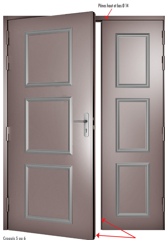
Croquis 5 ou 6 serrure sur 1 crémonne sur 2 (semi-fixe) Trou de crémonne dans la traverse sur place par vos soins
