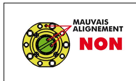
7. Insérer le nouveau cylindre intérieur en évitant tous contacts avec l'entraîneur. Faire pivoter le cylindre en le maintenant par le culot pour faire coïncider les trous de vis du culot avec les trous taraudés du coffre en s'assurant que la fente de l'entraîneur soit parallèle à la tétière et perpendiculaire par rapport aux 2 plats du culot ci-dessous.
