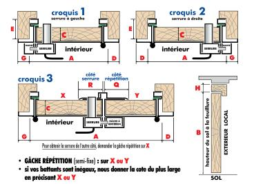
Pose en scellement ou entre maconnerie Portes s'ouvrant vers l'intérieur Avec soudure de 3 éléments de tube 40 x 27
