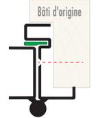
**Bâti pour pose entre maçonnerie**
