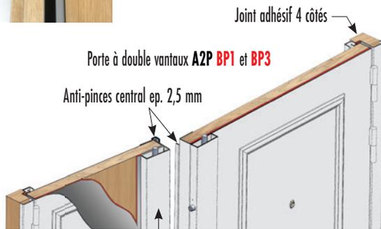
Ce 2<sup>ème</sup> vantail se manœuvre avec la clé de la serrure de l'ouvrant
